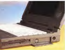
Periferiche delle porte di collegamento con il mondo esterno e sportello che cela l'eventuale floppy-disk.
